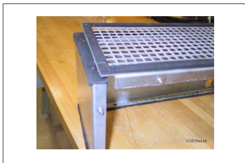
圖 3.41: 墊片會折過邊緣處以便將導管與上方排出蓋密封起來。
