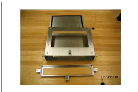
圖 3.52: 部分安裝的底部導管工件
