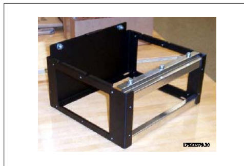
圖 3.62：部分組裝完成的基座部分
