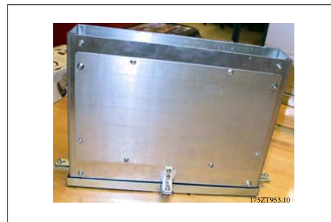
圖 3.53: 完全組裝好的底部導管工件
