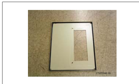
Рисунок 3.40: Верх корпуса Rittal с вырезом. Стандартные корпуса Rittal уже имеют вырез. Прокладка в этом вырезе не используется. Прокладка является частью воздуховода.
