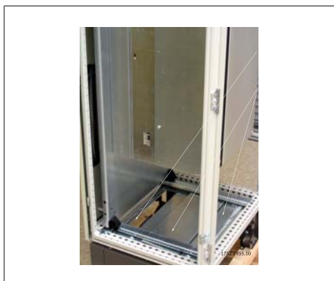
Рисунок 3.55: Нижний вырез корпуса
