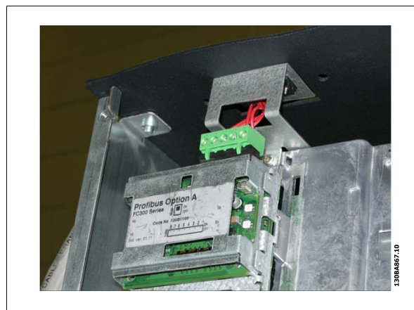
Afbeelding 3.49: Boven aansluiting voor veldbus
