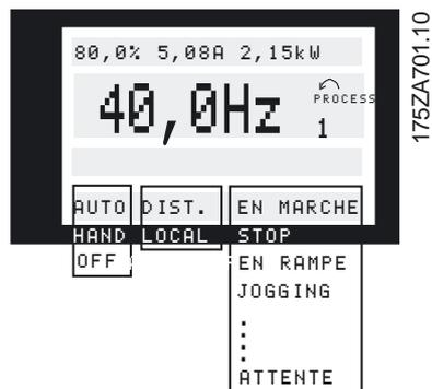
La partie gauche de la ligne d'état indique l'élément de commande actif du variateur de fréquence. AUTO signifie que le contrôle se fait par les bornes de commande, alors que HAND signifie que le contrôle se fait par les touches locales sur l'unité de commande.
