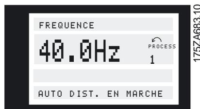
La ligne 2 indique la fréquence de sortie actuelle et le Process actif.
