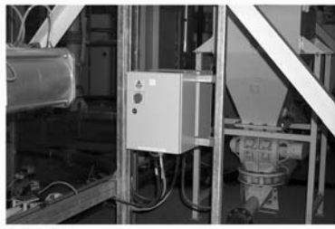
Illustration 1.14: Ancienne solution : commande de moteur montée sur panneau de façon décentralisée
