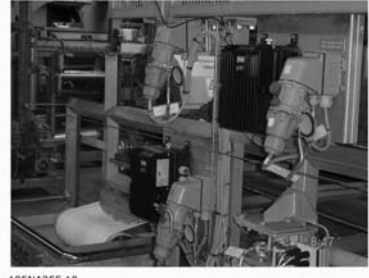
Ilustración 1.17: Uso eficiente del espacio en la industria alimentaria gracias a los controles de motor descentralizados de Danfoss.
