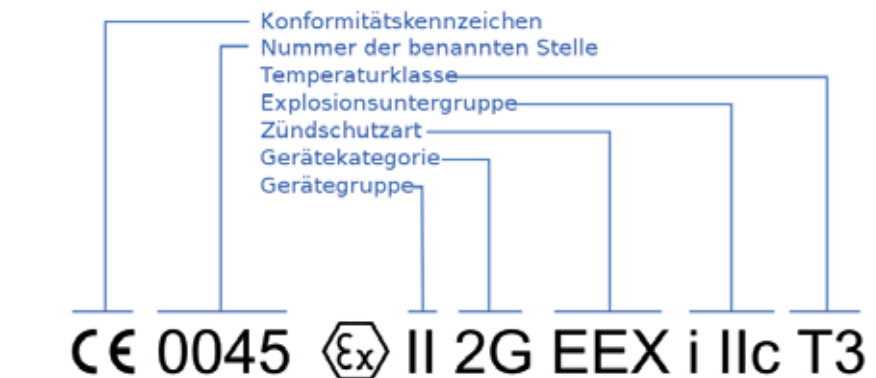
Kennzeichnung von Geräten für den Betrieb in explosionsgefährdeten Bereichen nach ATEX Produktrichtlinie 94/9/EG
