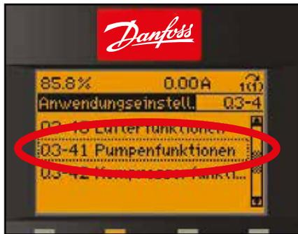
Umrichter den Leistungsbedarf des Pumpensystems nach. Grundlage für die Berechnung ist die Eingabe der benötigten Motorleistung bei zwei definierten Motorfrequenzen. Die Ermittlung der hierfür erforderlichen Werte kann manuell oder automatisch erfolgen.
