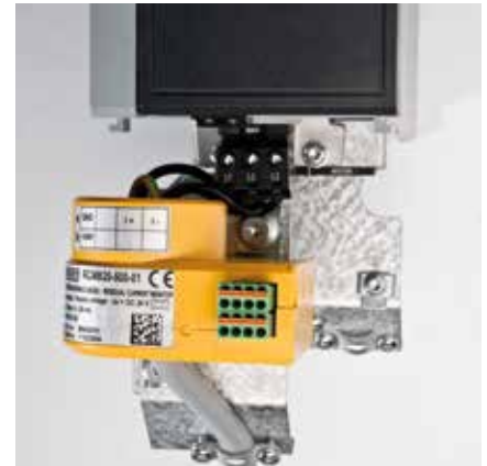
Das mitgelieferte Schirmblech vereinfacht die Installation und garantiert bei sachgemäßer Verdrahtung einen EMV-gerechten Anschluss.
