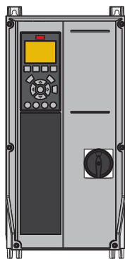
A4 IP55 avec sectionneur secteur
