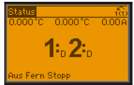
Der Status der Verdichter kann am Display abgelesen werden. D = Drehzahl geregelt, O = Aus, R = Netzbetrieb, X = Deaktiviert
