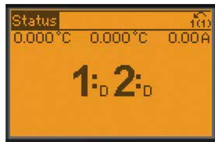
Status sprężarki można odczytać bezpośrednio z wyświetlacza. D = zmienne sterowanie prędkością, O = wyłączona, R = praca na zasilaniu sieciowym, X = nieaktywna
