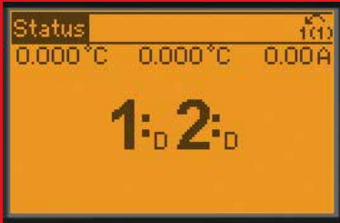
压缩机状态可从显示屏上直接读取。 D=变速控制, O=关闭, R=主电源运行, X=禁用
