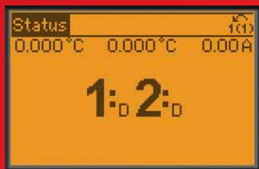
Visualizzazione dello stato del compressore direttamente dal display. D = controllo della velocità variabile, O = spento, R = funzionamento rete, X = disattivato
