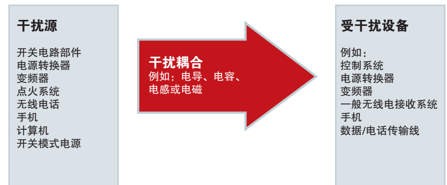
电磁干扰耦合途径概览和典型示例
