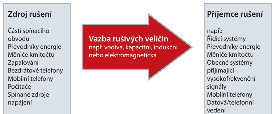
Přehled vazebních drah elektromagnetického rušení a typické příklady
