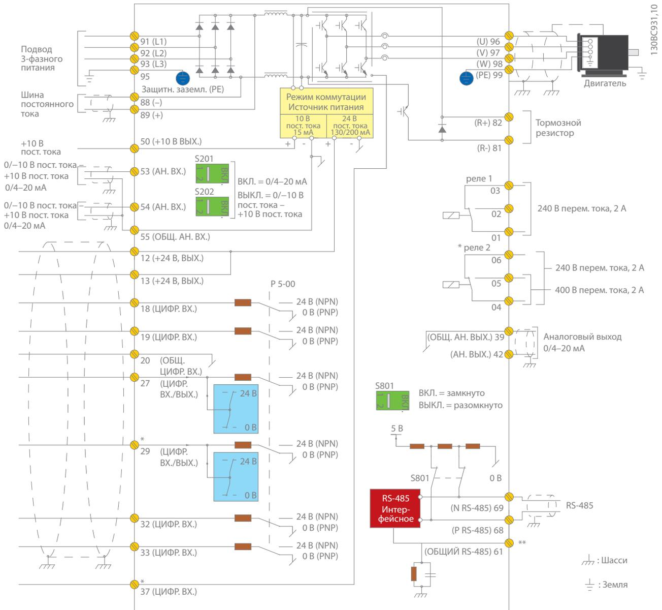
На рисунке представлена типовая схема подключения преобразователя частоты VLT® AutomationDrive. Питающая сеть подключена к клеммам 91 (L1), 92 (L2) и 93 (L3), двигатель подключается к клеммам 96 (U), 97 (V) и 98 (W).
