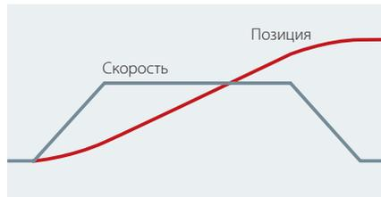
Рис. 1. Профиль перемещения с линейным изменением скорости
