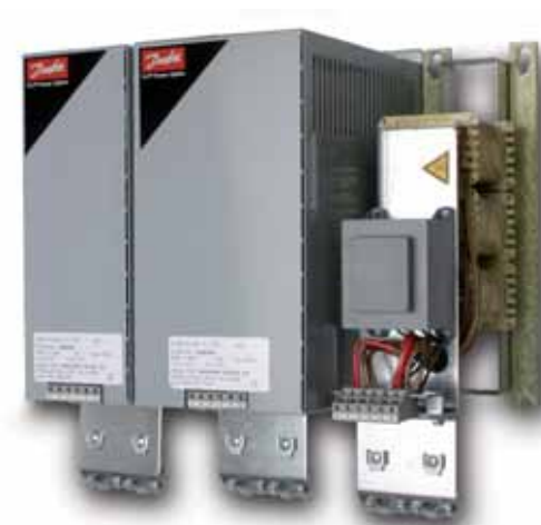
Výstupní filtry IP20 (nalevo) nebo IP00 (napravo) redukuje špičková napětí V_{peak} a rychlost sledování dv/dt moderních měničů kmitočtu, a chrání tím izolaci motoru.
