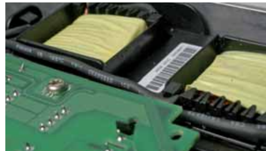
Napájecí tlumivky stejně jako tyto tlumivky v meziobvodu účinně snižují harmonické.
