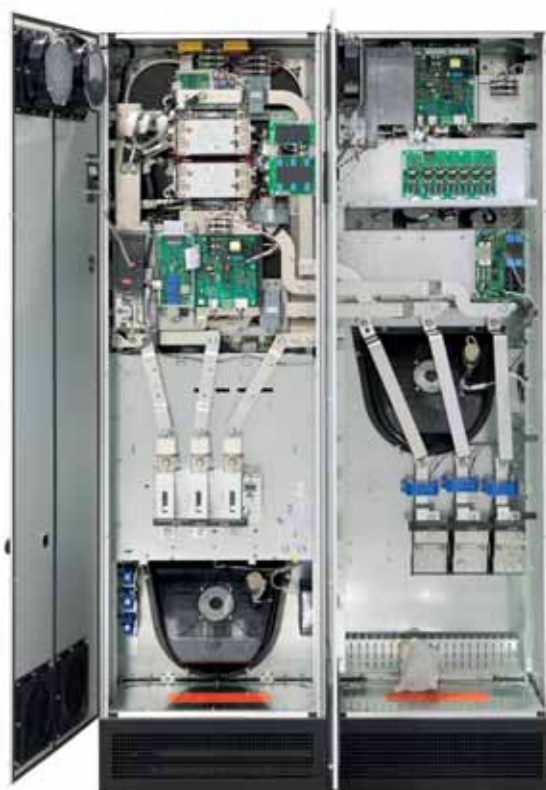
Měniče kmitočtu Low Harmonic Drive představují kombinaci s vestavěným aktivním filtrem, který potlačuje negativní účinky měniče na napájecí síť.
