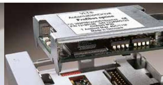
L'opzione bus di campo pronta per il collegamento all'interno del pannello frontale. È possibile ruotarla in caso di ingressi cavi dall'alto.
