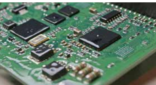
Upravljačke štampane ploče sa zaštitnim premazom su na raspolaganju za upotrebu u agresivnim sredinama.
