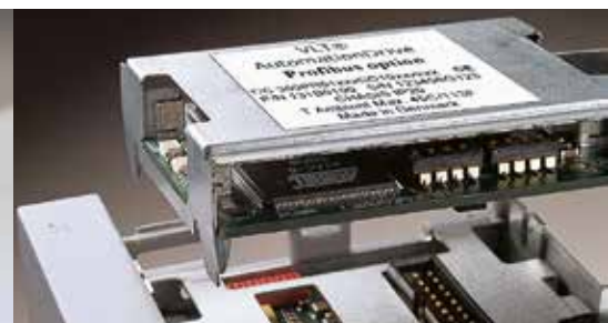
Doplněk komunikace nebo vstupů/výstupů je připraven pro připojení pod předním panelem. Volitelně lze vyvést propojovací komunikační kabel spodem společně s řídicími kabely nebo naopak samostatně vrchní stranou měniče kmitočtu.
