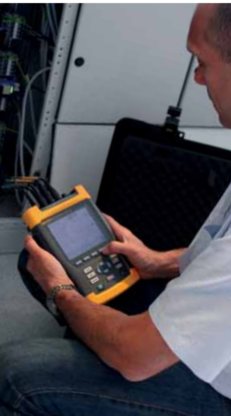
Danfoss kan op lokatie metingen verrichten naar harmonischen en aanbevelingen doen voor passende filtering.
