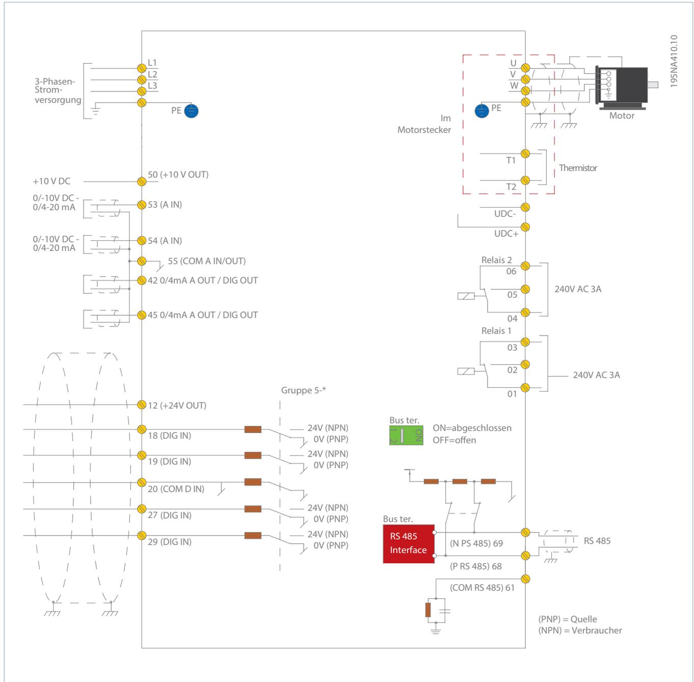
Das Diagramm zeigt die Klemmen des VLT® DriveMotor FCM 106 und des VLT® DriveMotor FCP 106.
