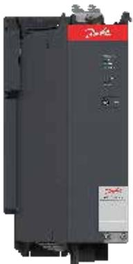
Das Versorgungsmodul PSM 510 erzeugt eine Zwischenkreisspannung von 565–680 V DC und ist in drei Leistungsvarianten mit 10, 20 oder 30 kW erhältlich (Überlastfähigkeit 200 %). Der Parallelbetrieb von zwei PSM 510 Modulen ermöglicht eine Nennleistung von bis zu 60 kW.
