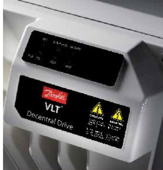
Die Kühlrippen des VLT® Decentral Drive FCD 302 sind schräg angeordnet. Damit ist ein schneller und zuverlässiger Ablauf von Reinigungs- und Desinfektionsmitteln sichergestellt. Sechs LED zeigen jederzeit den aktuellen Status des Geräts an. Für die Programmierung und weitere Informationen steht eine graphische Bedieneinheit bereit, die identisch zu den bewährten LCP-Bedienheiten der FC-Serie ist und ohne Öffnen des Gehäuses anzuschließen ist.
