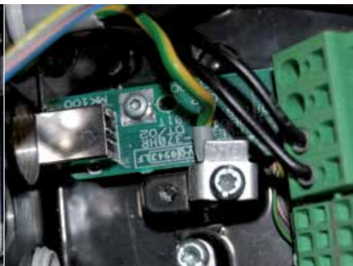
Einfach zugängliche Klemmen für interne Schleifenausführung
