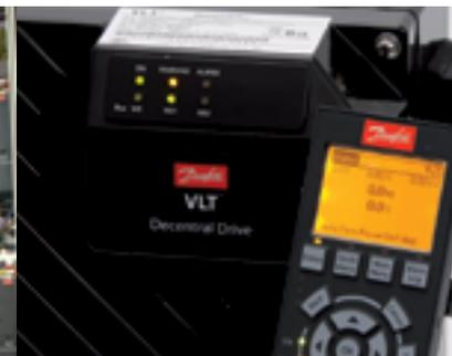
为了简化参数设置，可以连接 LCP 102 (FC 系列的图形控制单元)。
