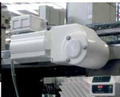
Der VLT® OneGearDrive® Standard mit einem Klemmgehäuse (eine optionale Bremse ist verfügbar).
