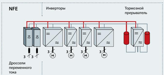
Система с общей шиной постоянного тока состоит из одного или нескольких модулей выпрямителя и модулей инверторов, соединенных между собой через шину постоянного тока
