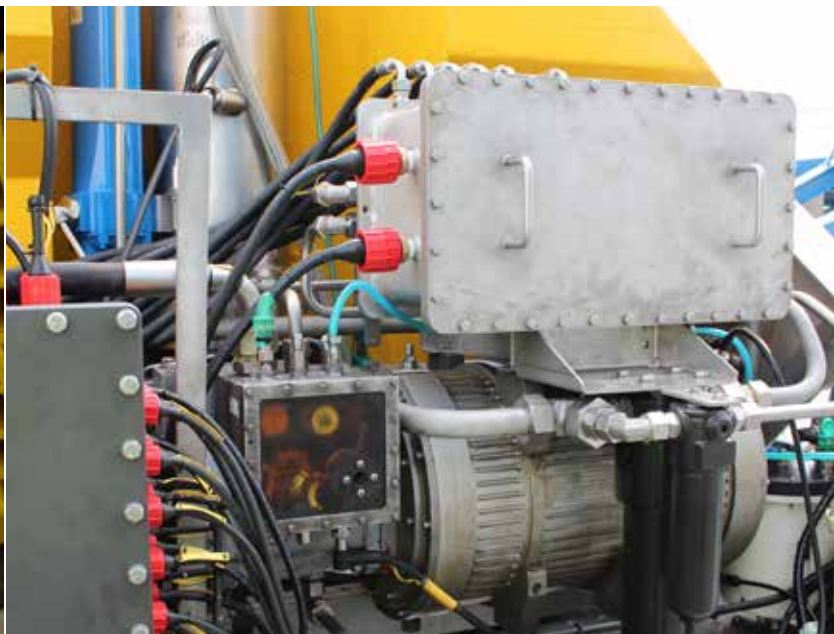
左图：直接安装在 ROV 上的高压泵，可通过船舶上的 VLT® 变频器进行控制。此高压泵可向刀头提供喷射水。 右图：用于液压系统的电机可控制牵引带、刀头液压系统和推进器，并由 VLT® Soft Starter MCD 500 控制。
