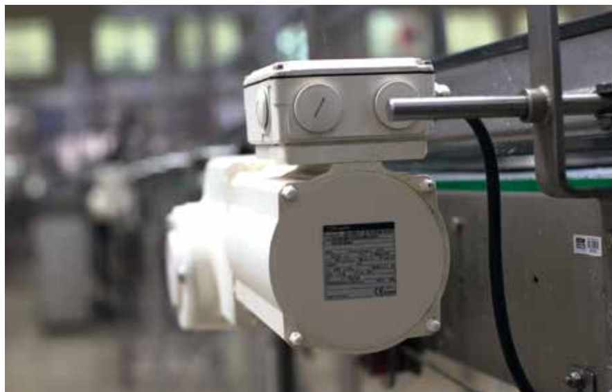
Os drives VLT ® controlam a velocidade das esteiras da linha de envase, tanto de forma descentralizada...
