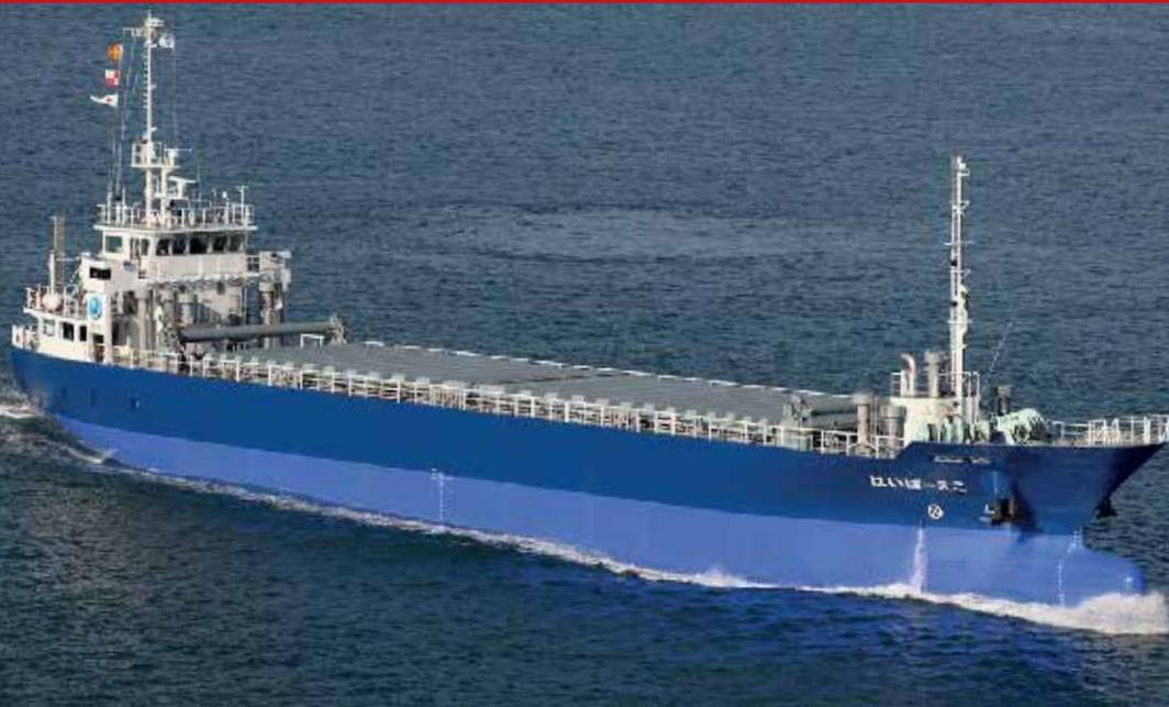
过去散装船使用柴油-机械推进，随着电力推进技术的发展，现已实现了诸多优点，如高冗余度、设备布局灵活性、节能和减少废气排放。经过长期研究，日本船东 Mukaishima Dock 公司决定建造一艘电力推进的散装船，主要用于日本内海的钢铁运输。这艘船开启了散装船电动推进的新时代。
