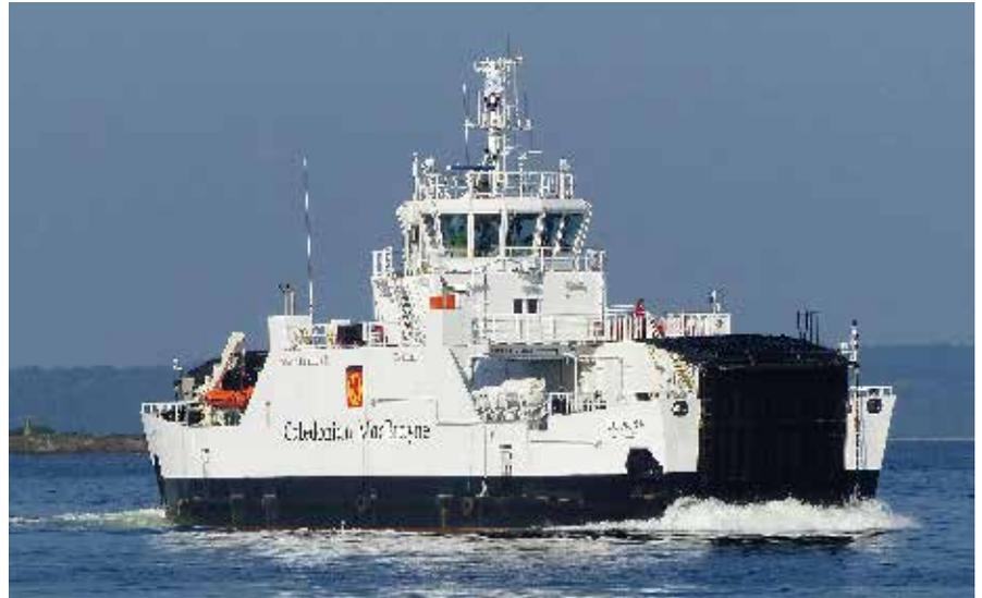
相比于减少20%燃料消耗和排放的目标，这艘船实际上实现了38%的燃料消耗减少。预计这将使船舶整个使用寿命期间的二氧化碳排放量减少超过5,500吨，硫和氮氧化物的排放量也会相应减少。
