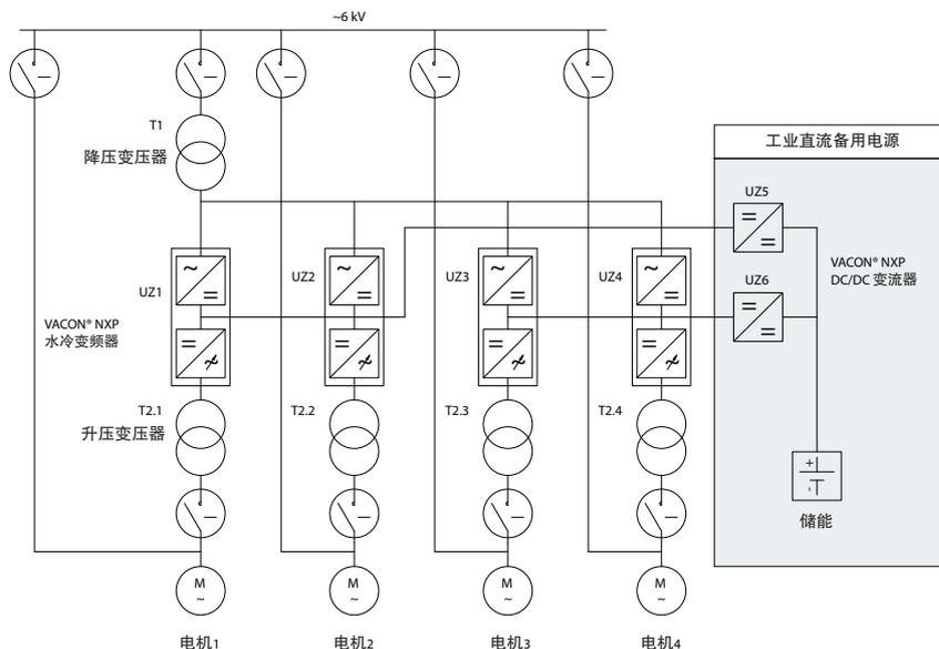
图1：电厂工业直流备用电源的原理图
