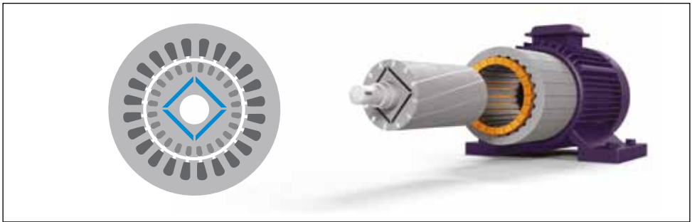
Fig. 1.26 De positie van magneten in de rotor beïnvloedt de motorkarakteristieken
