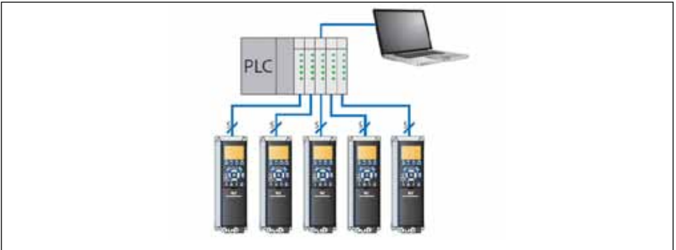
Fig. 8.7 Traditionele bedrading zonder veldbus.
