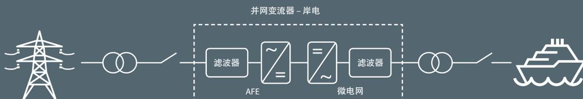
图2：岸电系统原理图。
