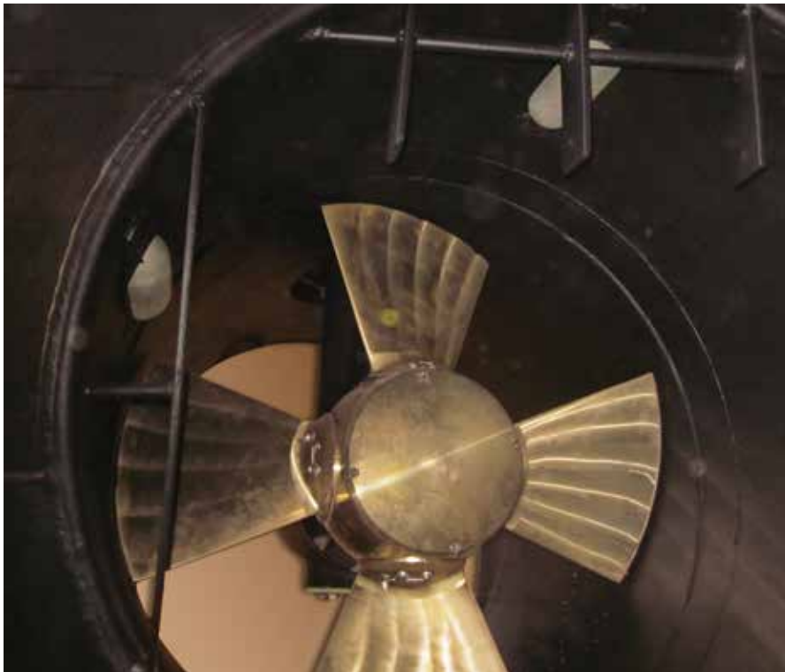
Tunnel thruster aboard the MV Fugløyhav
