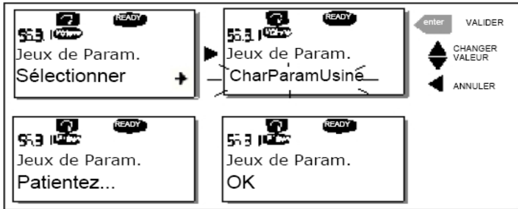
Figure 7-11. Procédure de sauvegarde et de chargement des jeux de paramètres
