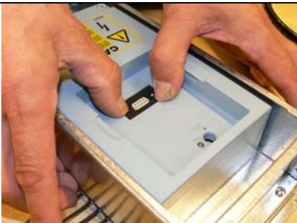
13.将密封条装在 RS485 连接器周围。
