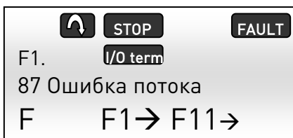
Рисунок 5.1-1. Ошибка потока на панели NXP
