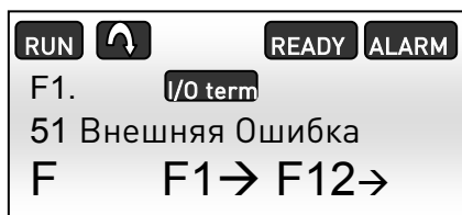
Рисунок 5.1-5. Аварийный сигнал наличия протечки на панели NXP
