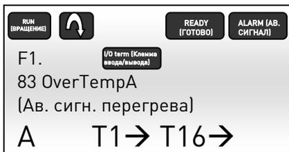
Рис. 7.1-2. Аварийный сигнал высокой температуры на панели NXP
