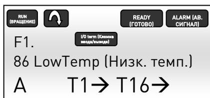
Рис. 7.1-3. Аварийный сигнал низкой температуры на панели NXP
