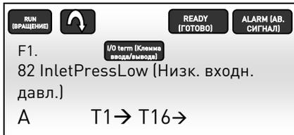
Рис. 7.1-4. Аварийный сигнал низкого давления на панели NXP
