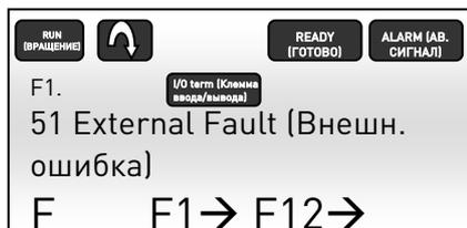
Рис. 7.1-5. Аварийный сигнал наличия протечки на панели NXP
