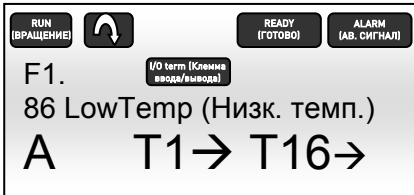
Рисунок 7.1-3. Аварийный сигнал низкой температуры на панели NXP
