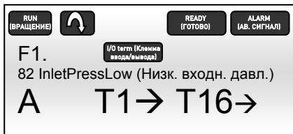
Рис. 7.1-4. Аварийный сигнал низкого давления на панели NXP
