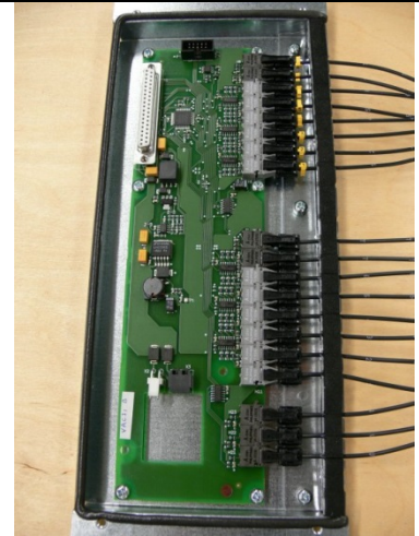
3. Cada cable de fibra óptica tiene un número 1...8 y 11...18 marcado en el cable apantallado en cada uno de los extremos del cable. Conecte cada cable a los conectores que están marcados con el mismo número en la tarjeta de acoplador en estrella. En el capítulo 2.1 aparece la lista de señales ópticas.
