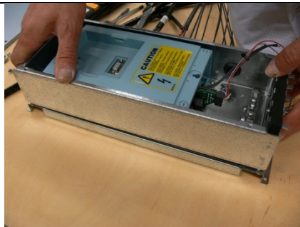
5. Cierre la cubierta empujando con cuidado para que el conector D conecte perfectamente.
