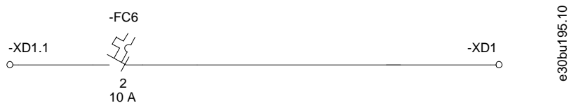
Ilustración 42: Terminales de alimentación de CA auxiliar
