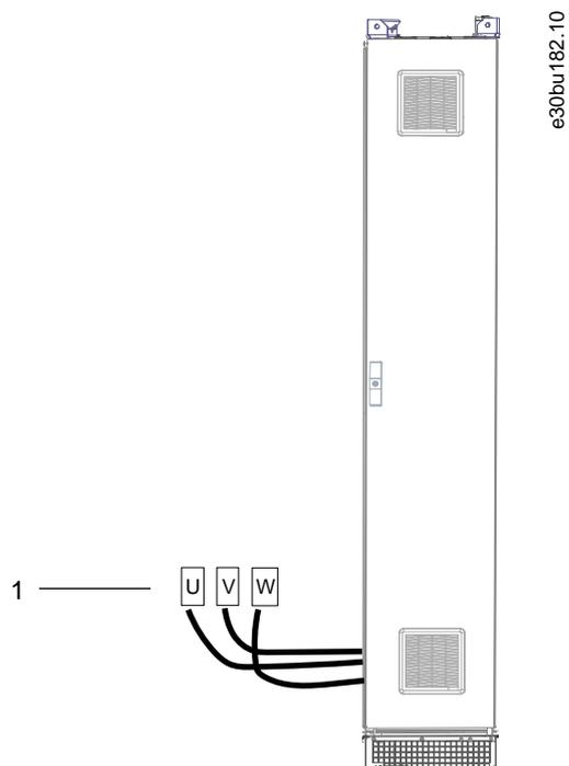
1 Кабели двигателя (U/V/W) к клеммам двигателя (U/V/W) в шкафу преобразователя частоты
