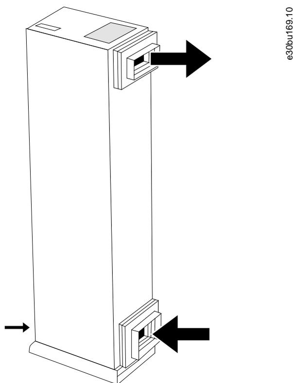
Рисунок 18: Расход воздуха в шкафу с опцией тыльного канала (фланцы-переходники для воздуховода не входят в комплект поставки)
