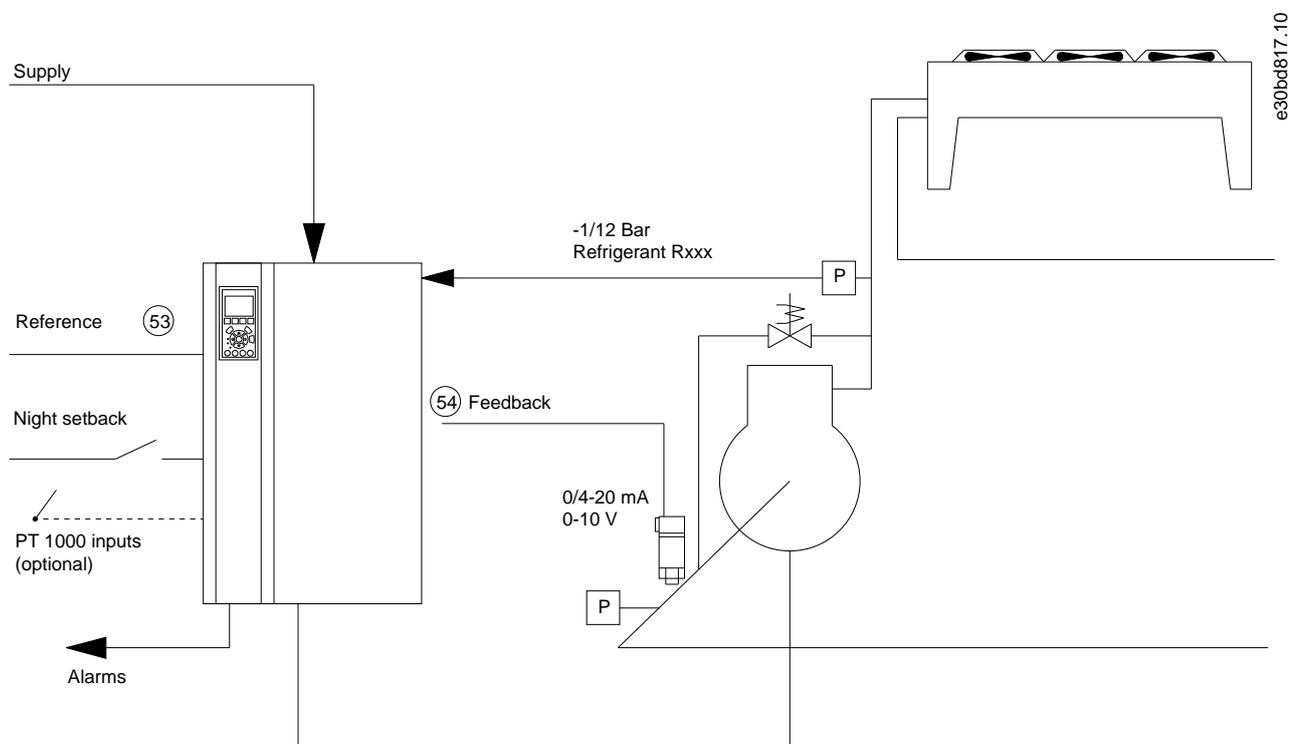
Рисунок 63: Стандартная конфигурация компрессора с внутренним управлением
