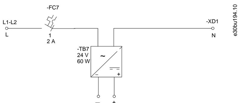
Рисунок 44: Клеммы внешнего питания 24 В пост. тока
