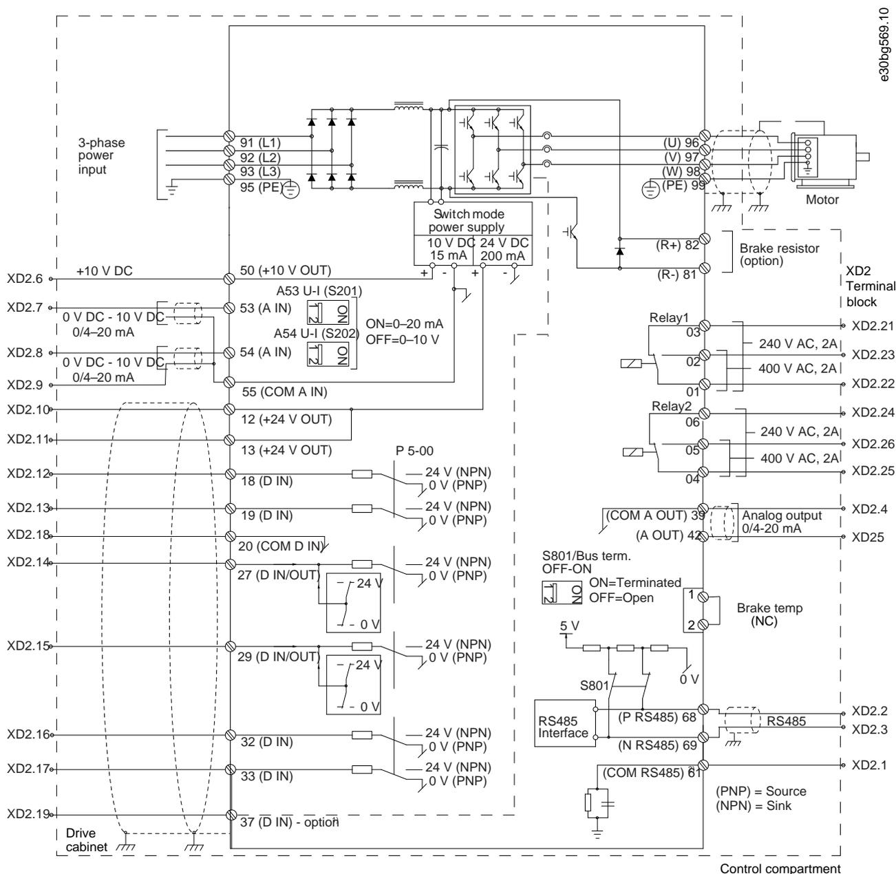
1 Клемма 37 (опция) используется для функции Safe Torque Off. Инструкции по установке см. в документе «Преобразователи частоты VLT® FC — руководство по эксплуатации функции Safe Torque Off».
