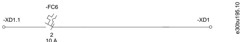
Рисунок 42: Клеммы вспомогательного источника питания переменного тока
