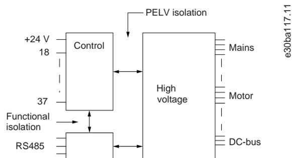
Рисунок 71: Изоляция PELV
