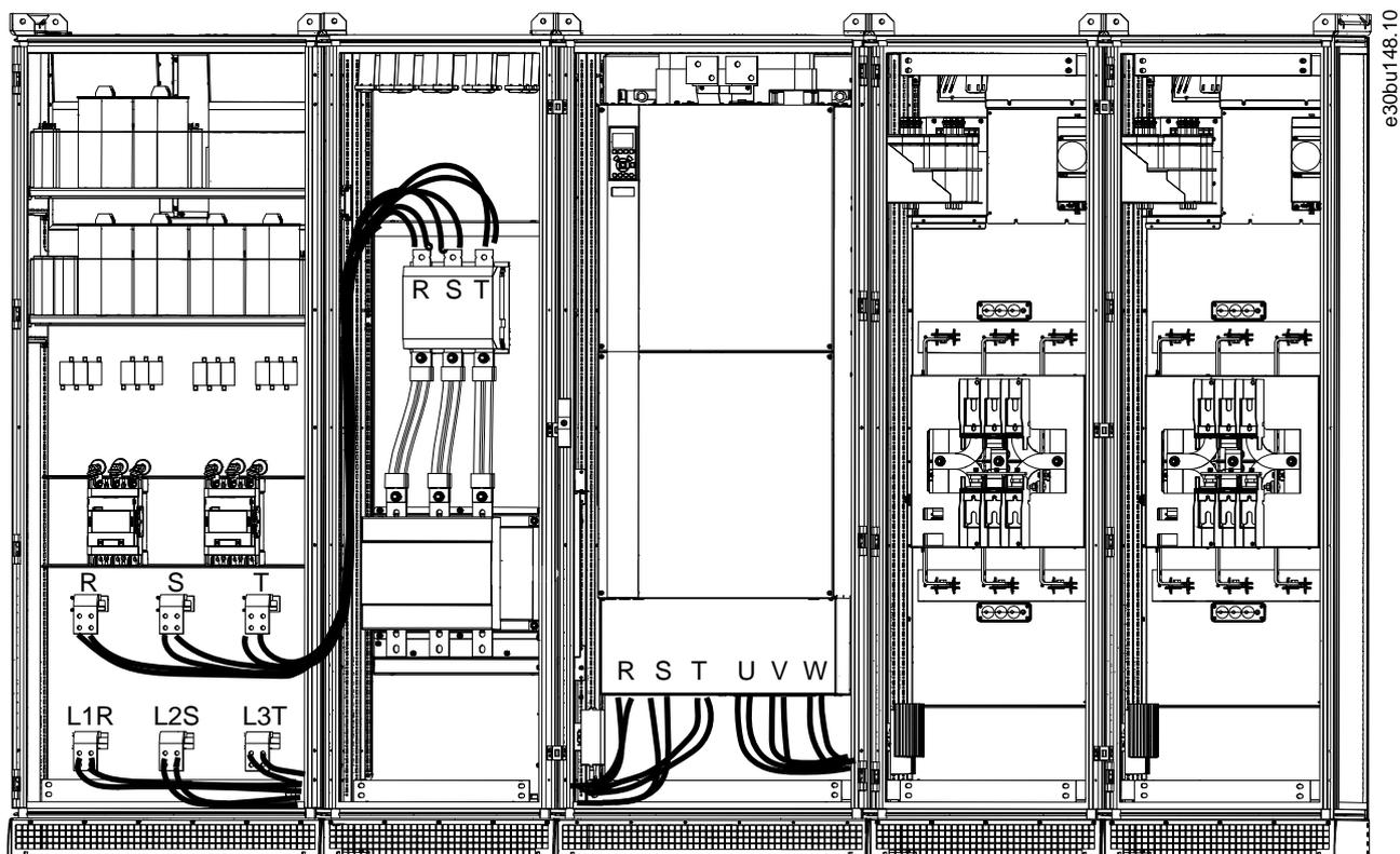
Рисунок 40: Подключение кабелей двигателя и сети питания (в пример показан шкаф PHF + шкаф доп. устройств входного питания + шкаф преобразователя частоты E6h + шкафы синусоидных фильтров)
