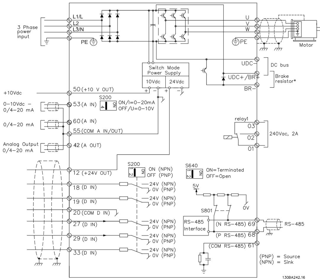
图 1.6 图中显示了所有电气端子
