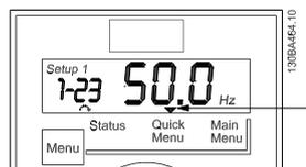
Ilustración 3.9 Indicación del modo Menú rápido
