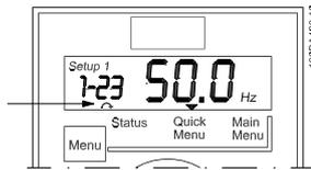
Disegno 3.7 Indicazione della direzione del motore
