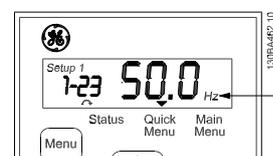
Abbildung 3.5 Anzeige der Einheit des ausgewählten Parameters
