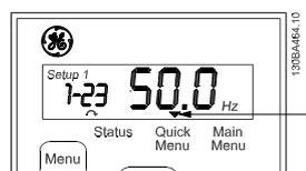
Abbildung 3.8 Anzeige des Quick-Menü-Modus
