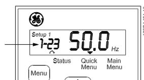
Illustration 3.3 Indication du numéro du paramètre sélectionné
